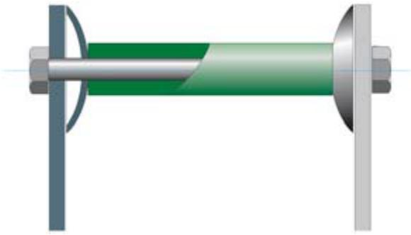
La funda es la única pieza del engranaje de tracción que sufre desgaste y se ha diseñado para que se pueda sustituir lo más fácilmente posible. La extracción y montaje de las fundas plásticas fijadas mediante tornillos se hace de forma rápida y sin esfuerzos.
