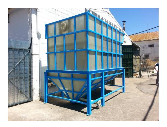
El Departamento Técnico de BIOLAM COLOMBIA S.A.S. está a disposición de nuestros Clientes para el diseño y proyecto de cualquier tipo de equipo de sedimentación y clarificación que se dimensiona en relación con la caudal a tratar y a la carga de solidos existente.
