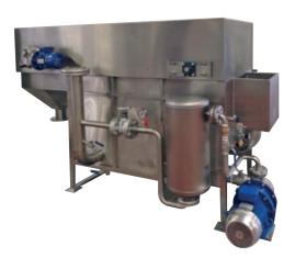
Il flottatore è un impianto per il trattamento chimico-fisico delle acque, esso utilizza aria disciolta per ottenere la separazione solido/liquido. L'introduzione dell'aria nell'acqua permette la creazione di bollocine d'aria che a contatto con le particelle sospese ne provochino la risalita in superficie modificando così la densità dei materiali.
